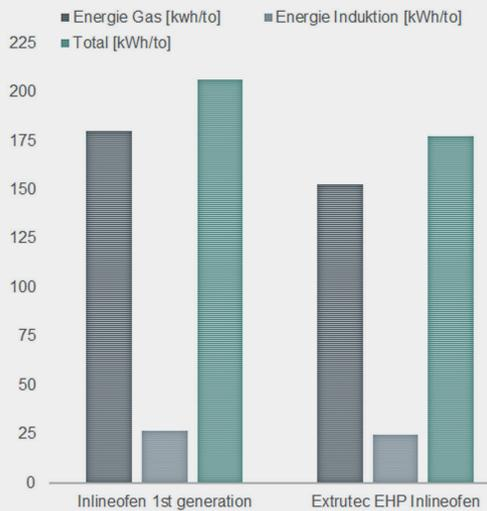
**Bild 7:** Gegenüberstellung des Energieverbrauches durch die Anlagenoptimierungen
